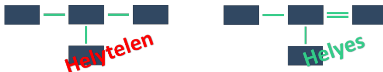
12. ábra - CAN busz, helytelen leágazás és a megoldása két vezetéssel
